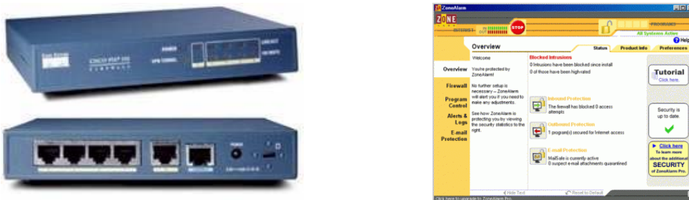
Slika 8: Strojna izvedba požarnega zidu (levo), uporabniški vmesnik programskega požarnega zidu (desno)
