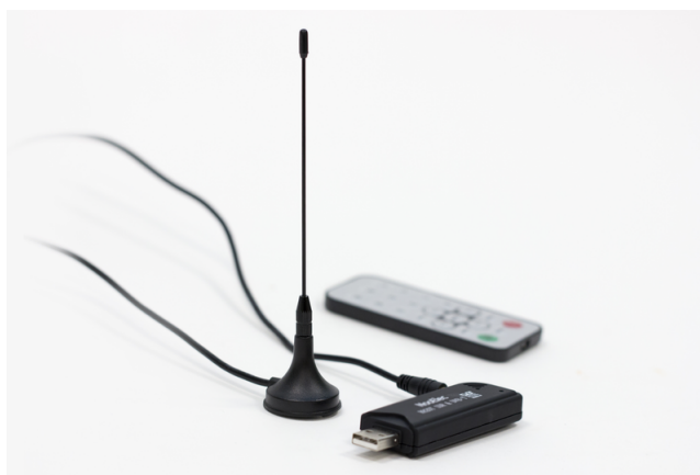
Slika 2: DVB-T USB sprejemnik oziroma RTL-SDR [35].
