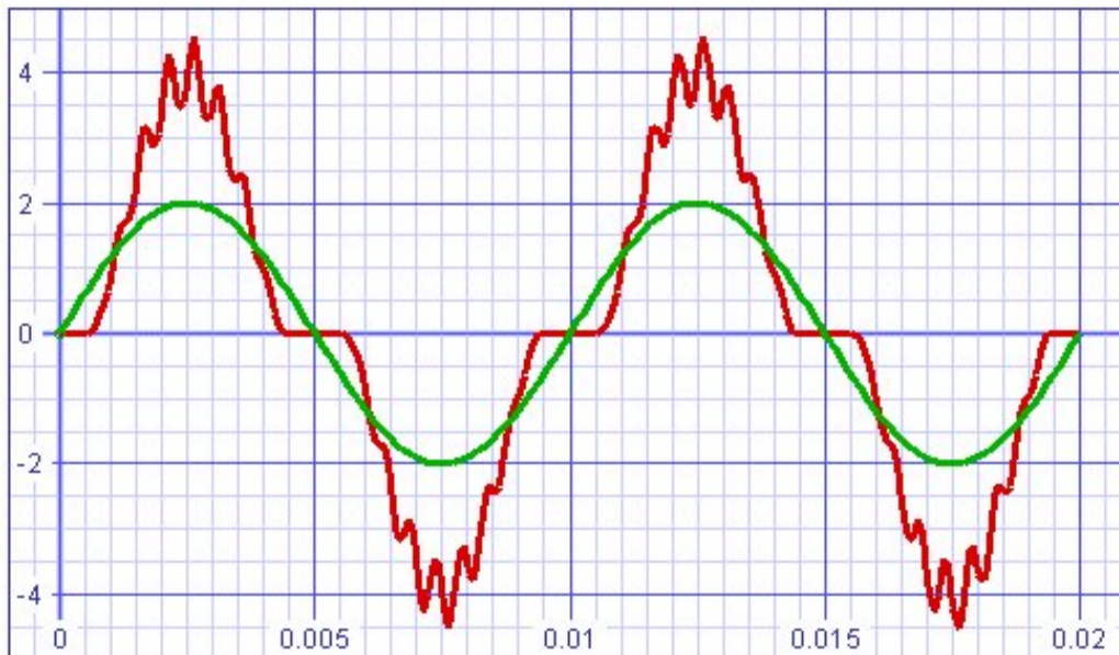
Slika 13: Vpliv valovitosti napajanja na bremenu
