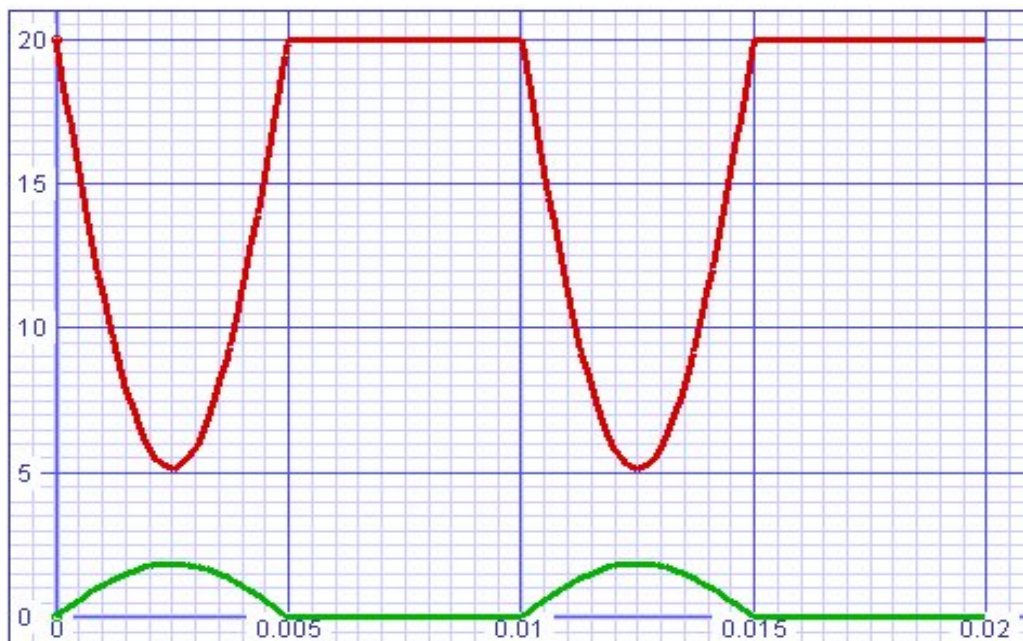
Slika 15: Napetost in tok na tranzistorju
