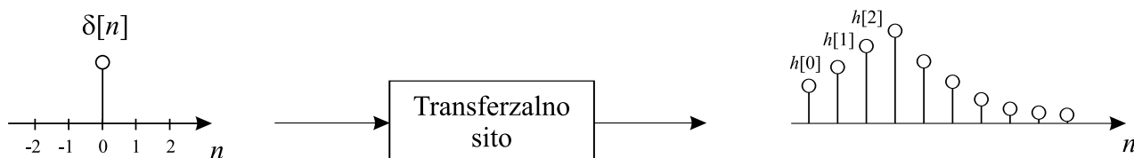
Slika 3.3 – Odziv transverzalnega sita na enotin impulz (sl3-3)
