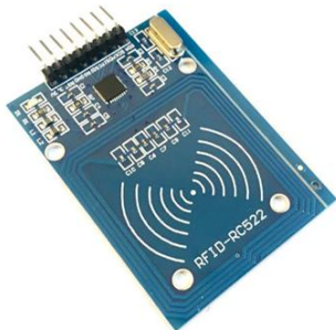
Slika 1. RC522 RFID čitalec kartic.
