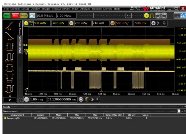
Slika 4. Časovni potek komunikacije med čitalcem in kartico. Rumena krivulja je moduliran nosilec, torej surov napetostni signal iz H sonde, spodnja (oranžna) krivulja pa je amplitudna ovojnica, ki jo osciloskop sam izračuna.
