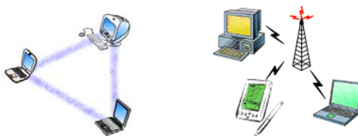
Slika 1: »Ad hoc« in osnovna postavitev omrežja WLAN
